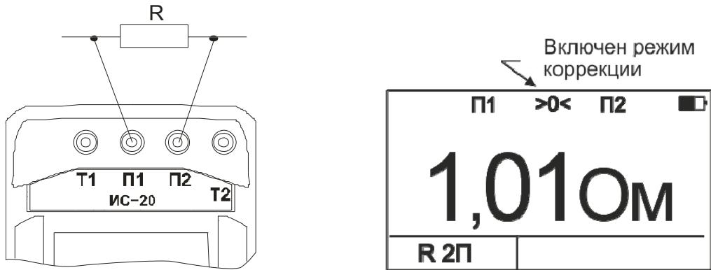
Рисунок 2.3.5.2 – Схема подключения и вид индикатора
