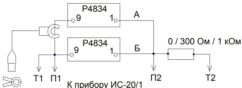
Рисунок 6.6.4 – Схема подключения прибора ИС-20/1 для измерения сопротивлений с одними клещами
