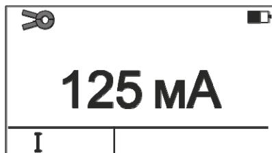
Рисунок 2.3.9.3 - Вид индикатора при измерении переменного тока
