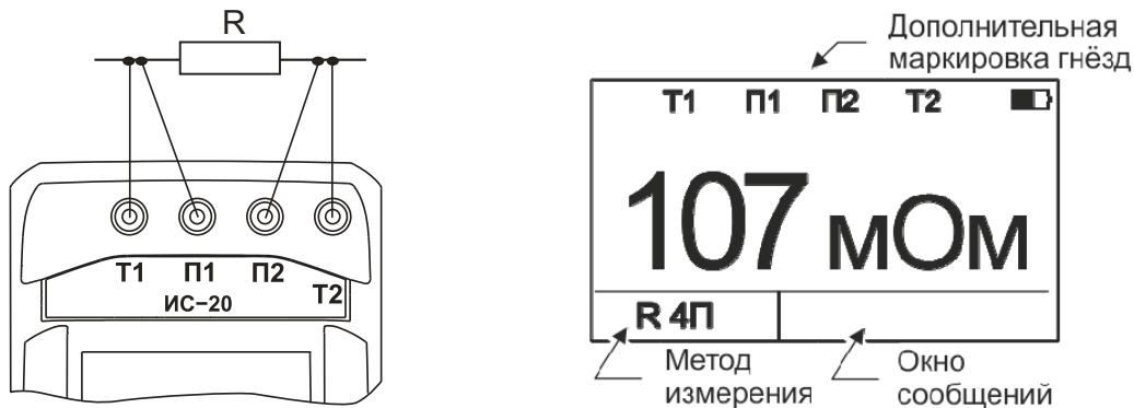
Рисунок 2.3.5.1 – Схема подключения и вид индикатора
