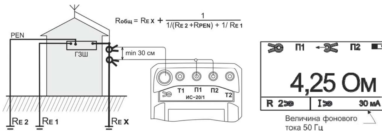
Рисунок 2.3.9.2 - Схема подключения и вид индикатора
