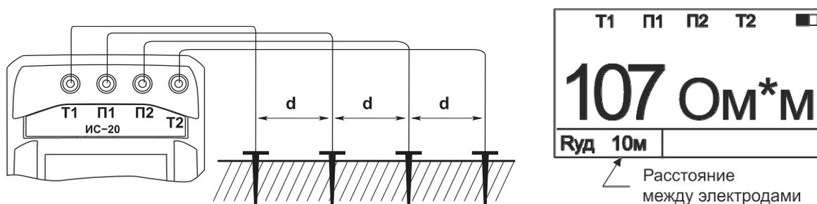
Рисунок 2.3.8 - Схема подключения и вид индикатора при измерении удельного сопротивления грунта
