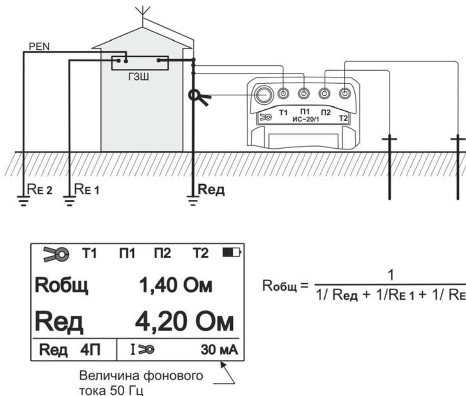
Рисунок 2.3.9.1- Схема подключения и вид индикатора при измерении сопротивления единичного заземлителя по четырехпроводному методу
